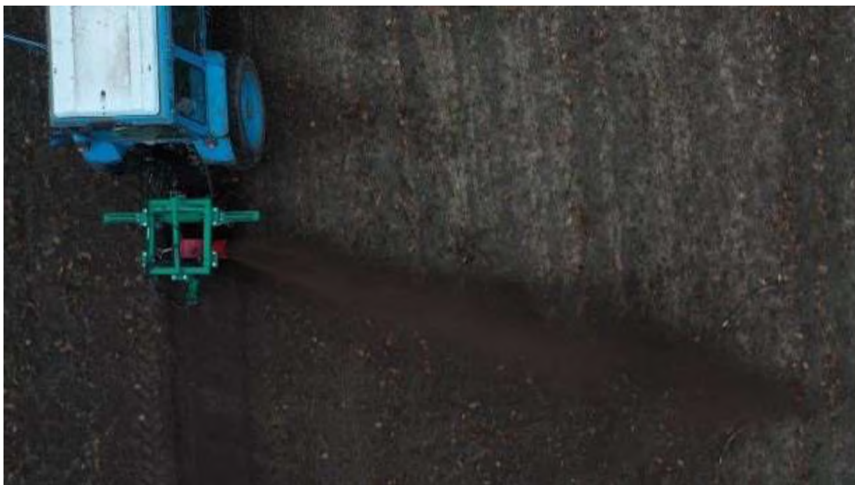
Рисунок 5.22 – Исходное изображение потока грунта вид сверху, полученное с видеокамеры беспилотного воздушного судна
