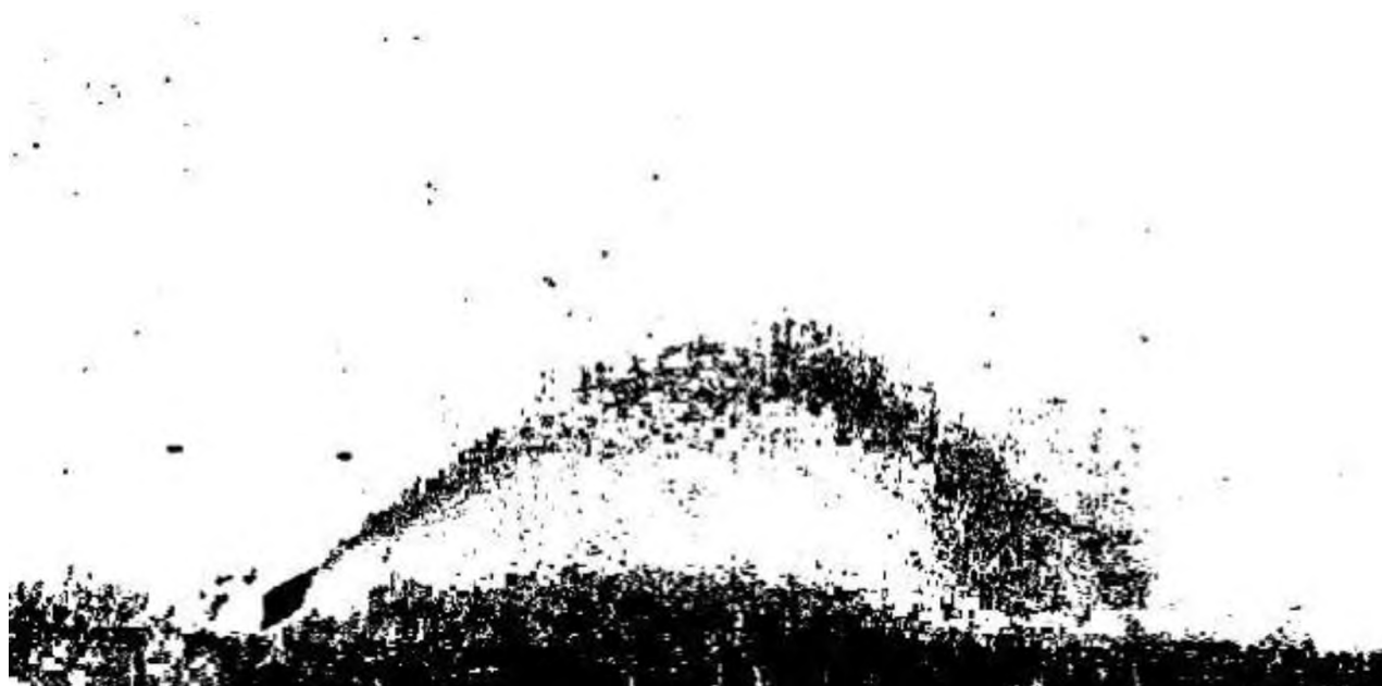
Рисунок 5.3 – Изображение потока грунта, полученное выделением красного ( R ) канала изображения в формате RGB
