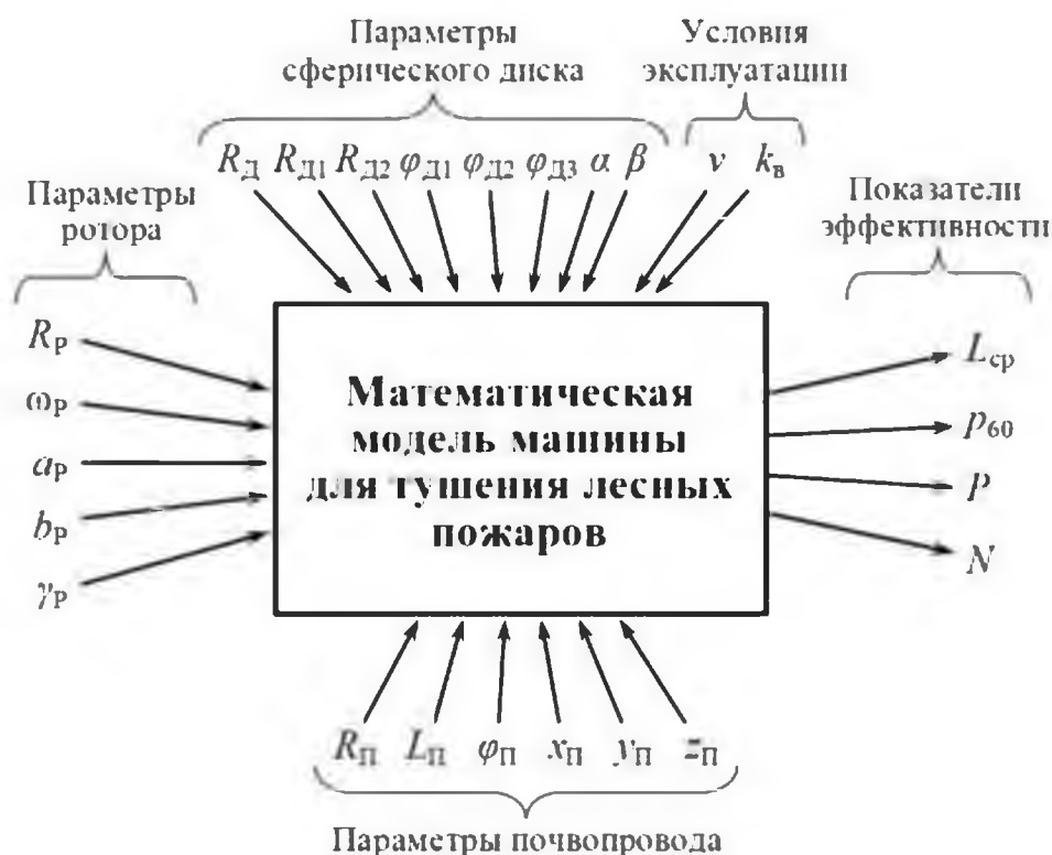
Рисунок 6.14 – Входные параметры и показатели эффективности модели грунтометательной машины
