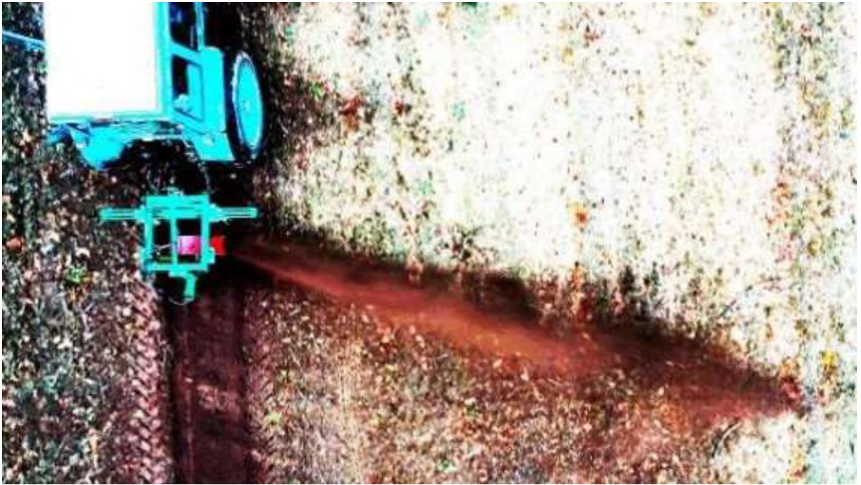
Рисунок 5.23 – При увеличении цветовой насыщенности видеокadra поток грунта может быть отделен от фона по цветояркостному принципу
