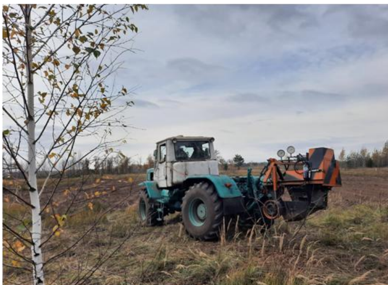
Рисунок 7 - Новая конструкция грунтометательной машины в агрегате с трактором Т-150К на полевых испытаниях
