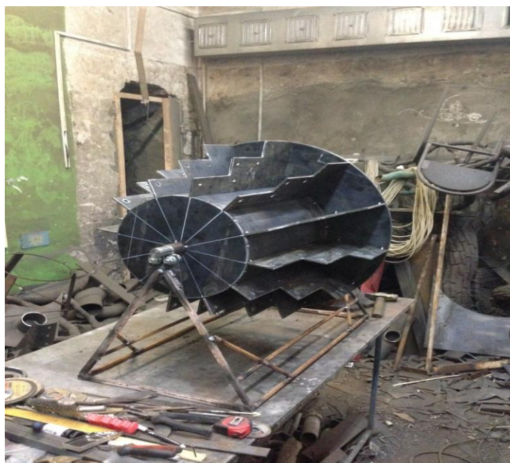
Рисунок 3.1 - Процесс сборки ротора-метателя
