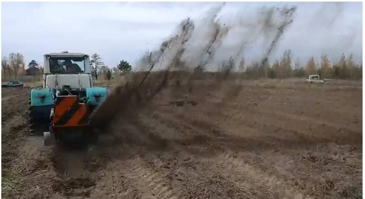
Рисунок 5.1 – Полевые испытания опытного образца лесопожарной грунтометательной машины с трехступенчатым ротором-метателем
