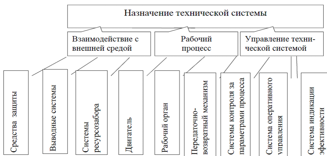
Рисунок 2.4 - Древесный граф назначения технической системы
