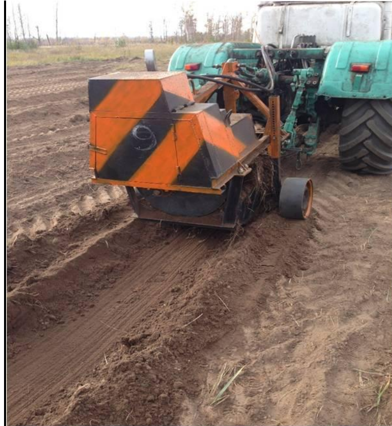
Рисунок 4.7 - Экспериментальный образец лесопожарного грунтомета в агрегате с трактором Т-150К
