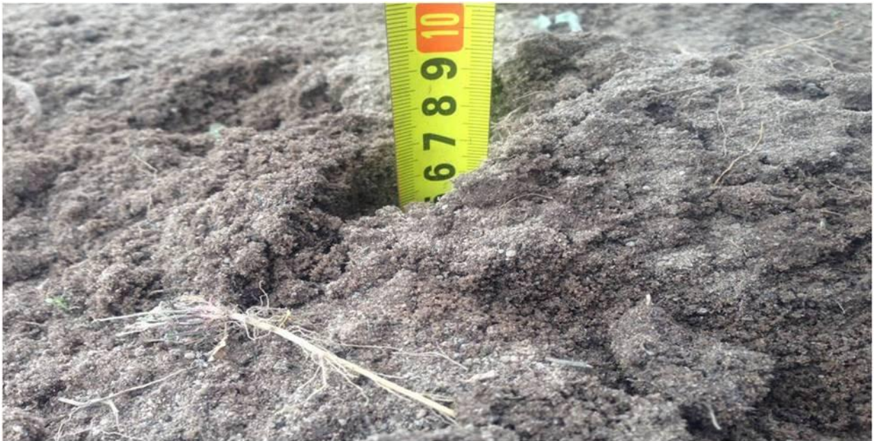
Рисунок 4.17 - Замеры толщины слоя метания грунта
