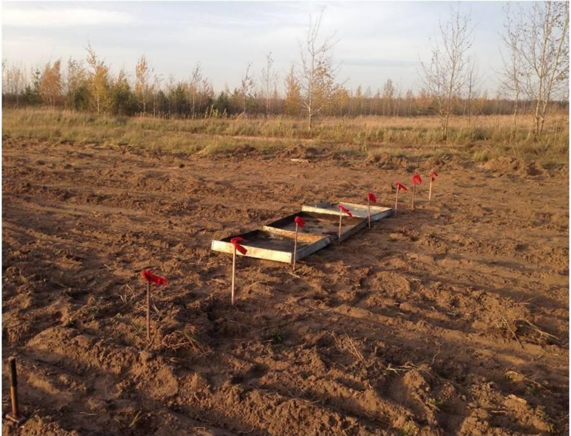
Рисунок 4.16 - Замеры дальности полета потока грунта
