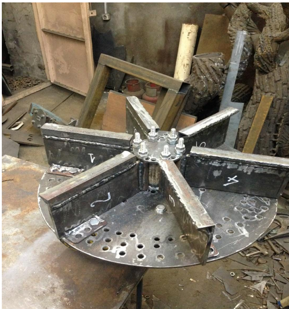
Рисунок 3.4 - Одноступенчатый ротор-метатель с поворотными лопатками для лабораторных исследований
