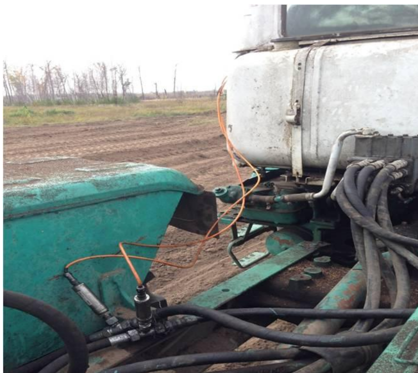
Рисунок 4.8 - Установка тензометрических датчиков в гидропривод ротора-метателя.
