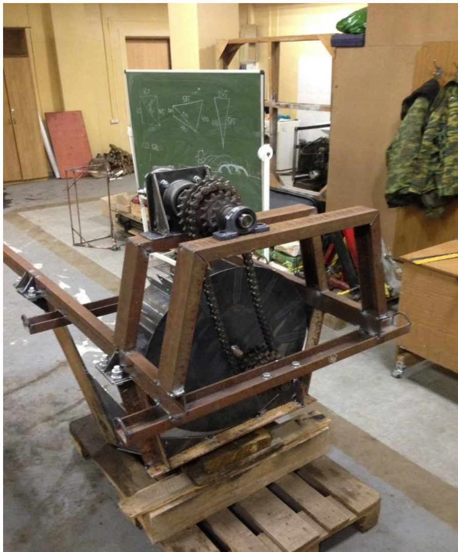
Рисунок 3.2 - Монтаж гидромотора привода ротора со сменными звездочками
