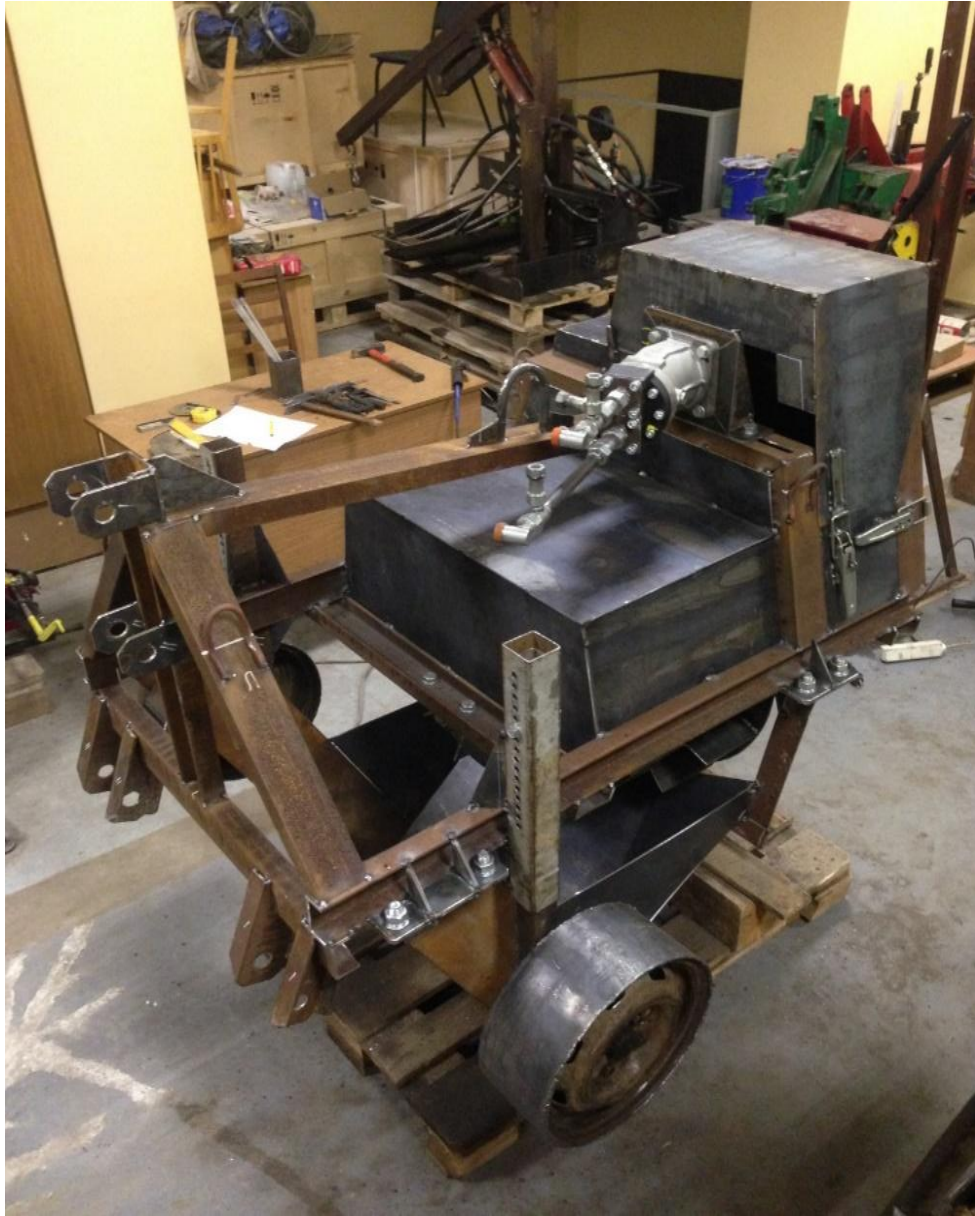
Рисунок 3.3 - Экспериментальный образец грунтомета со ступенчатым ротором-метателем для полевых исследований
