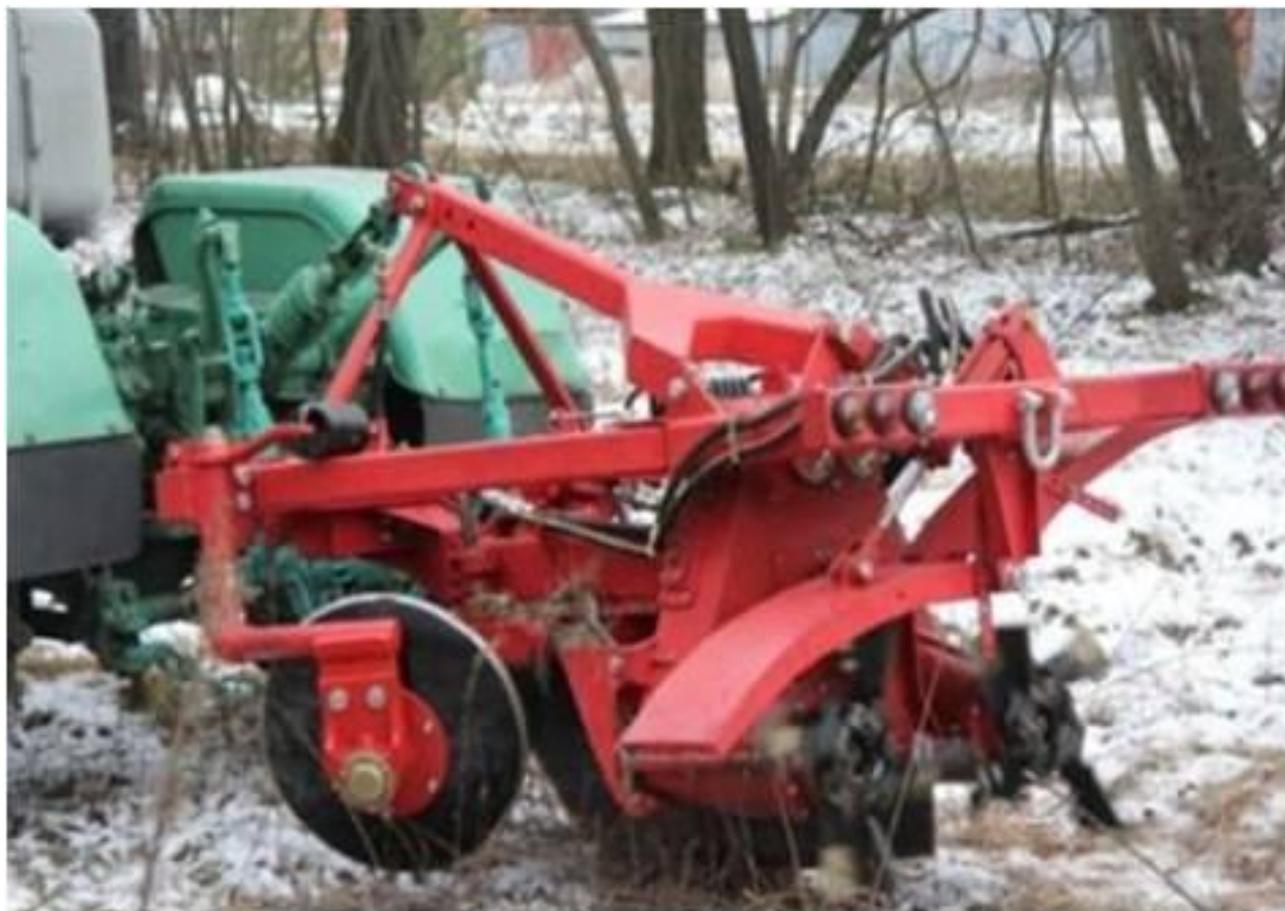
Рисунок 1.6 – Пожарный грунтомет – полосопрокладыватель
