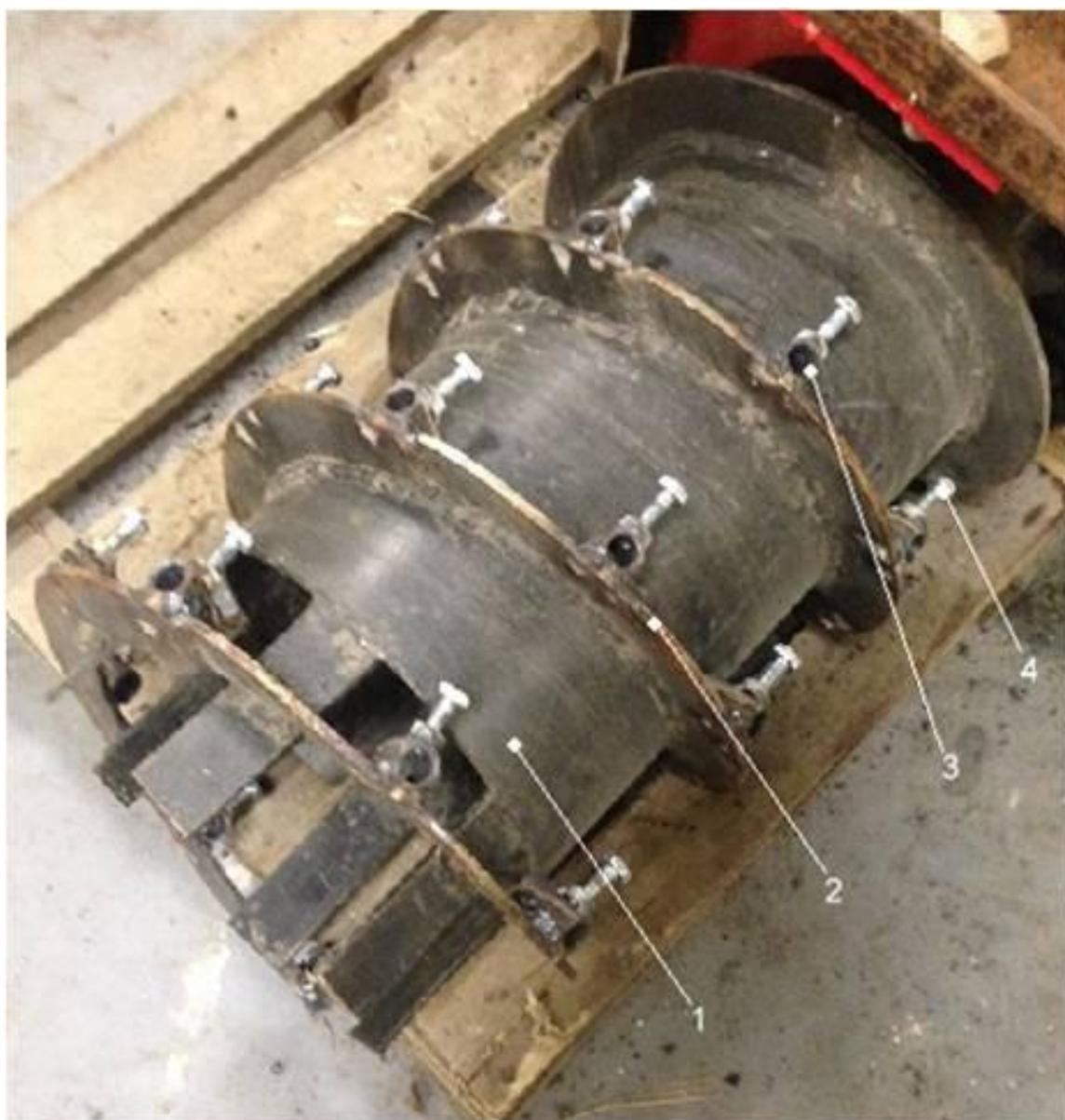
1 - труба барабана; 2 - лента шнека; 3 - втулки; 4 - стопорные болты
