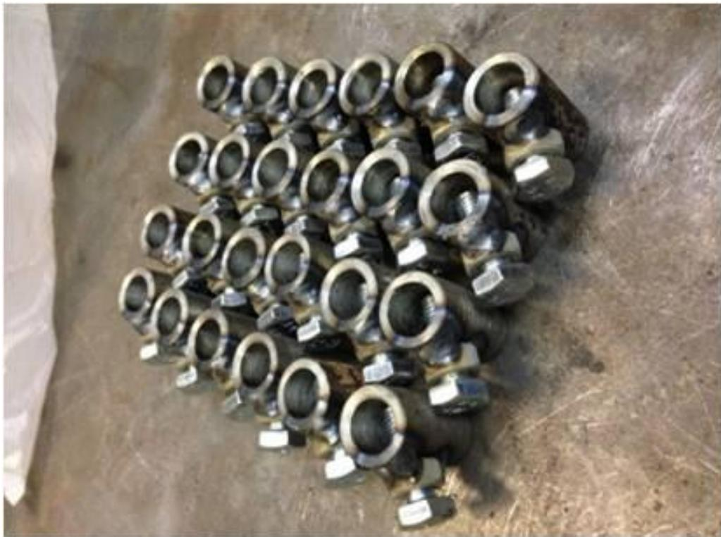
Рисунок 3.2 – Процесс изготовления втулок вид сверху с боковыми отверстиями и болтами для фиксации стержневых зубьев
