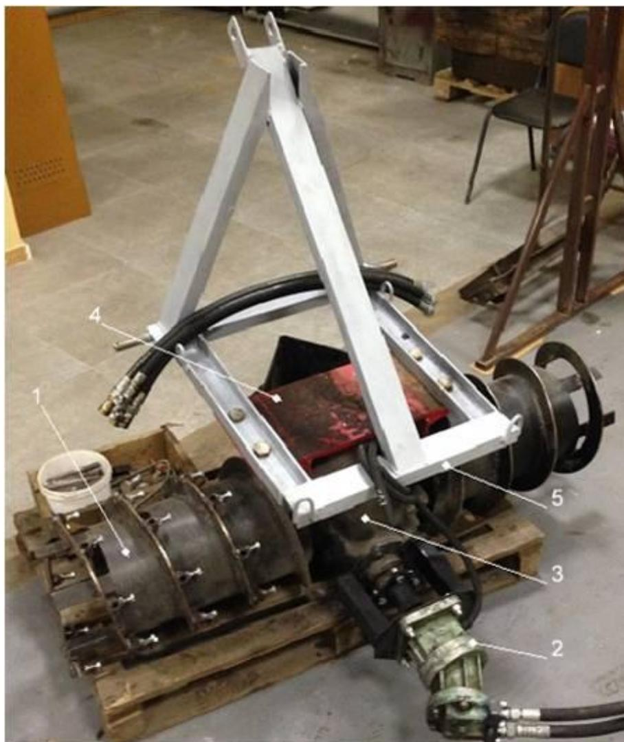
1 – барабан шнека; 2 – гидромотор; 3 – редуктор; 4 – рама
