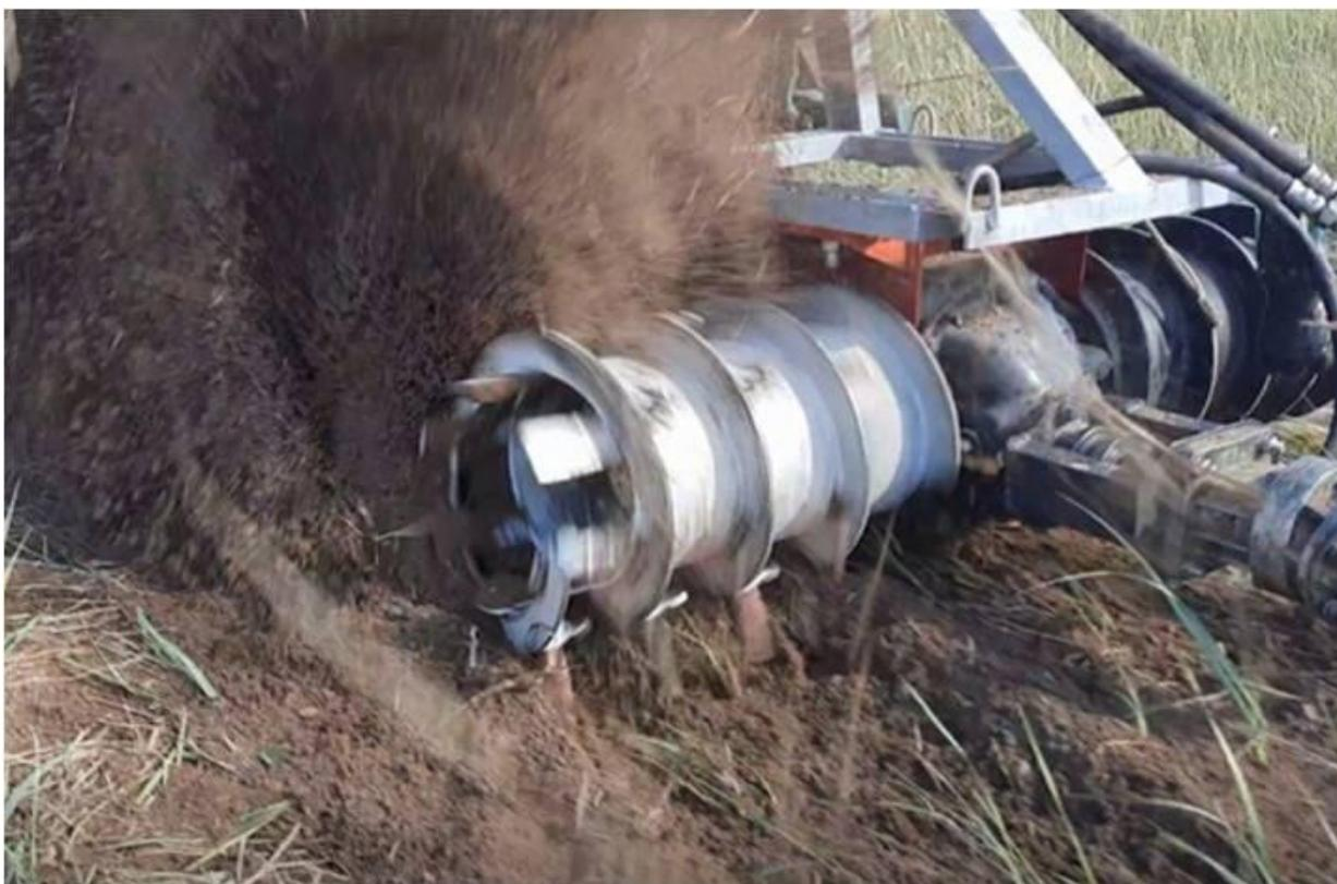
Рисунок 4.1 – Испытания лабораторной установки со шнековыми рабочими органами в работе
