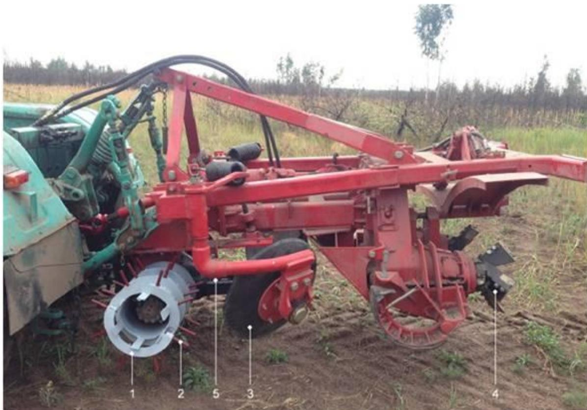
1 – шнековый рабочий орган; 2 – стержневые зубья; 3 – сферические диски; 4 – фрезы-метатели; 5 – гидромотор
