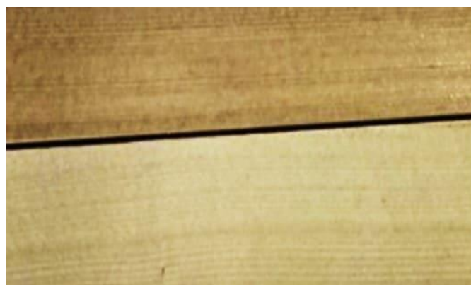
Рисунок 4.3 — Сопоставление дощечек выдержанной (сверху) и свежей (снизу) древесины ели
