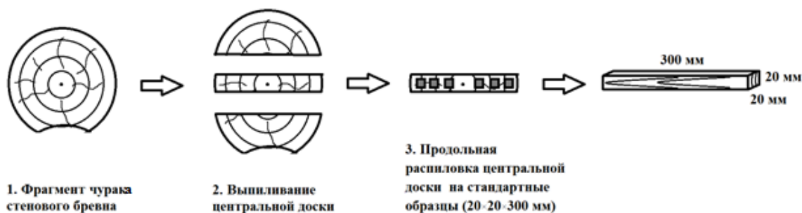
Рисунок 3.11—Схема отбора и изготовления образцов
