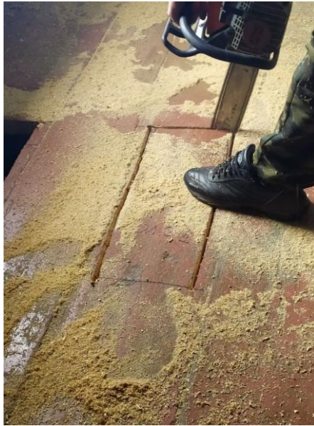
Рисунок 3.9 — Отбор пластин из половой доски
