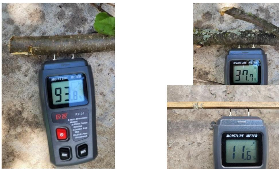
Рисунок 4.6 – Цифровой детектор влажности древесины RZ 01 Wood
