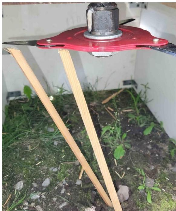
Рисунок 4.14 – Вид среза тонкой древесины диаметром 1 см.
