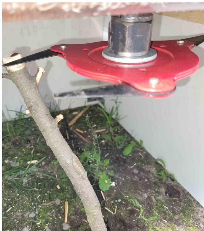
Рисунок 4.16 – Вид среза ветви диаметром 2 см
