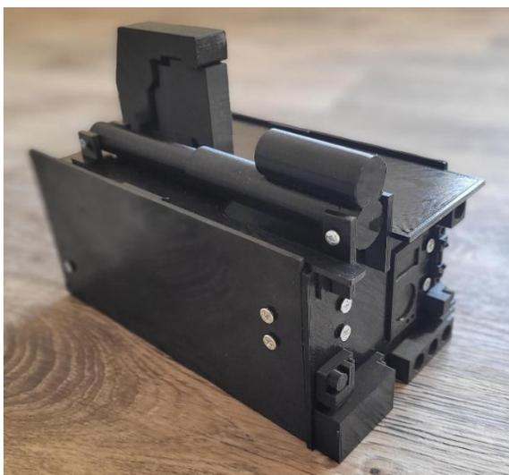
Рисунок 4.1 – Макет стенда для испытания ротора кустореза напечатанный на 3D принтере
