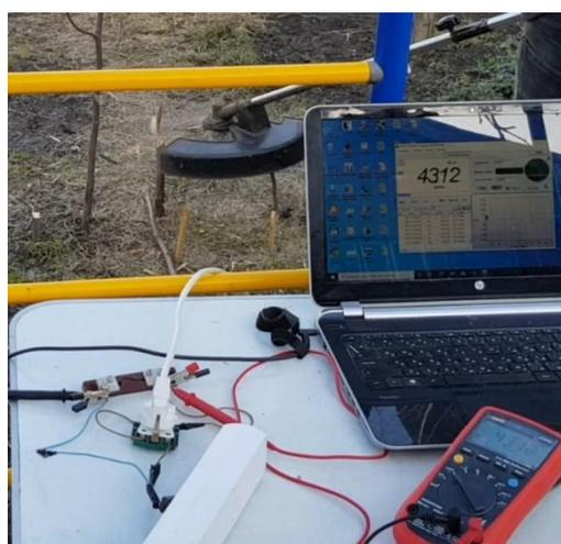
Рисунок 4.7 – Цифровой мультиметр UNI-T UT61E подключенный к компьютеру
