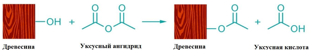
Рисунок 1.5 – Процесс ацетилирования древесины уксусным ангидридом
