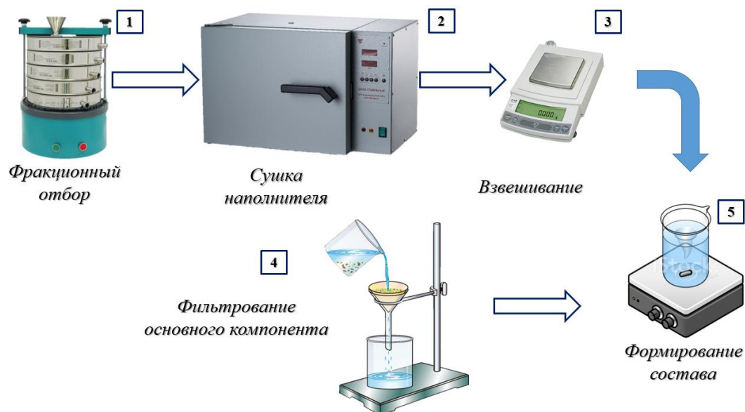
Рисунок 3.3 – Процесс получения композиционного пропиточного состава с древесным наполнителем
