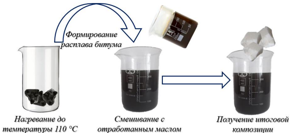
Рисунок 3.4 – Схема процесса формирования пропиточной композиции, для гидрофобизации и антисептирования древесины
