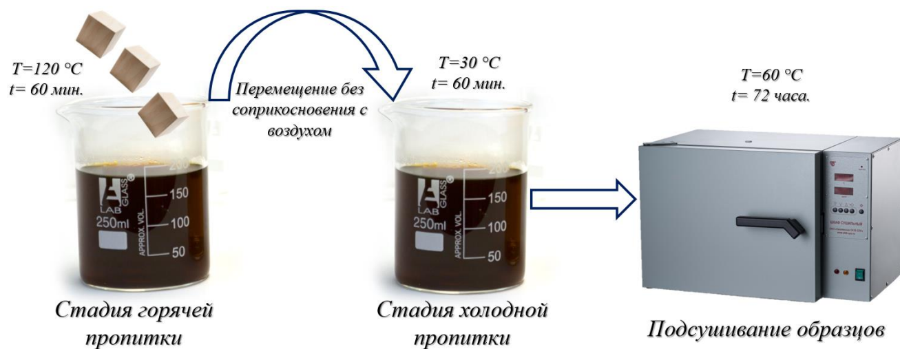
Рисунок 3.6 – Процесс пропитки древесины модифицирующими составами методом горяче-холодных ванн
