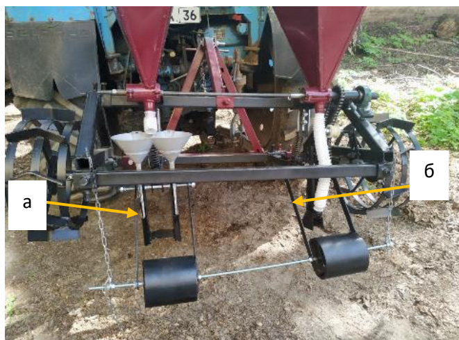
Рисунок 11 – Сеялка СТВ-2, оснащенная разрабатываемым сошником (а- разработанный сошник; б – стандартный сошник)
