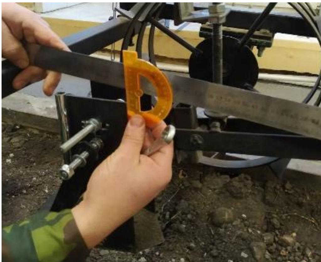
Рисунок 4.5- Регулировка угла вхождения сошника в почву
