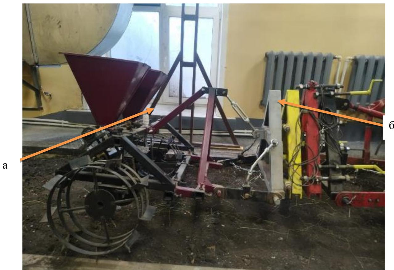
Рисунок 4.1 - Сеялка СТВ-2 с установленным новым сошником в почвенном канале кафедры МЛХ и ПМ
