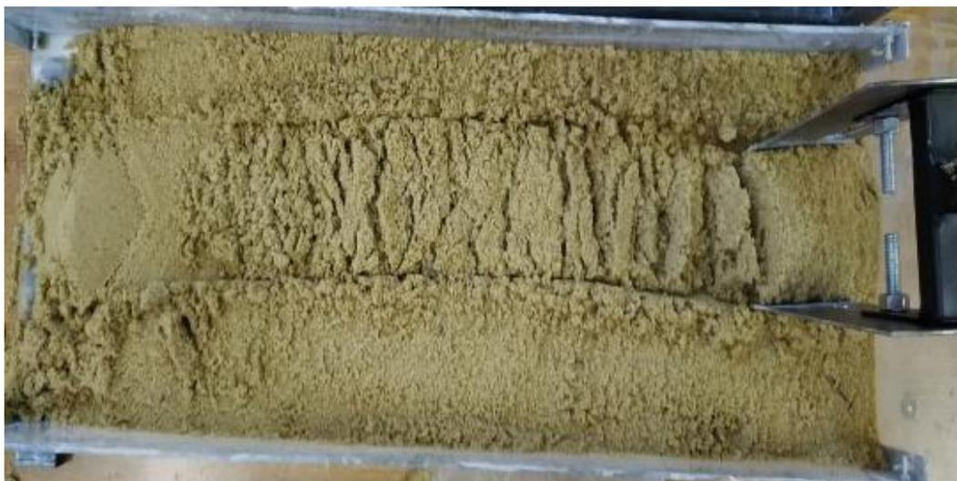
Рисунок 3.3 - Работа сошника в песчаном канале
