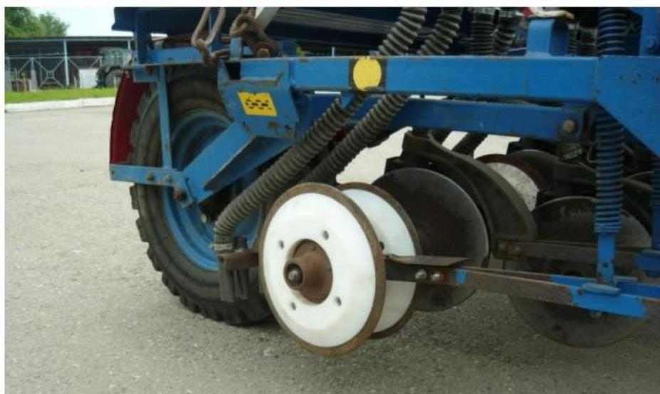
Рисунок 1.13 – Конструкция дискового сошника с включением полимерной вставки
