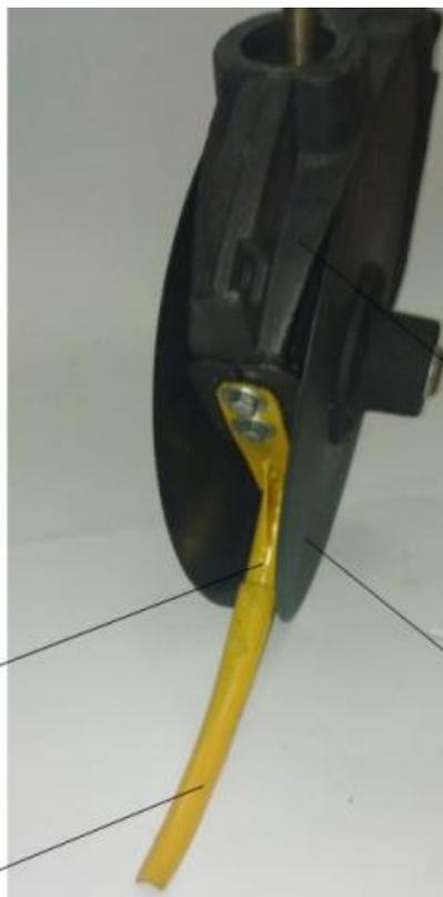
Рисунок 1.5 – Общий вид дискового сошника с узкой трубкой гасителя
